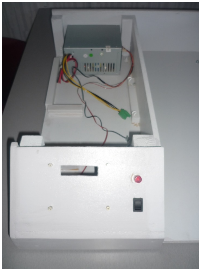
Partie gauche du boîtier avec son alimentation
